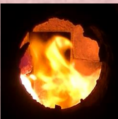
炉内旋回流による安定燃焼
